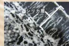
瀬の表面部分の断面（電子顕微鏡）
